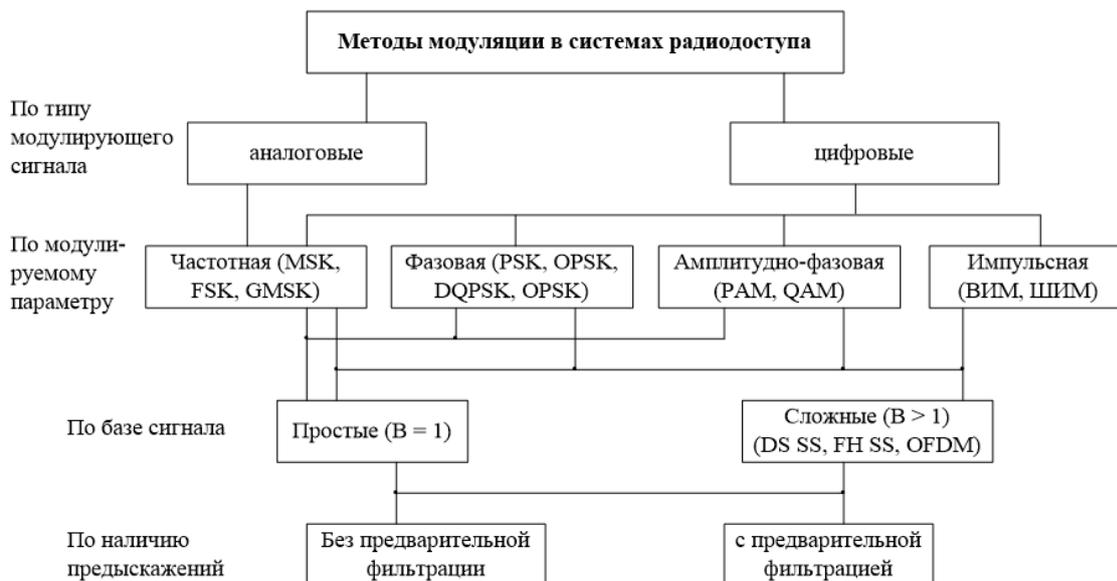
Рис. 1. Классификация методов модуляции
