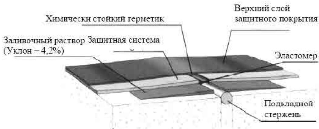
Рис. 3. Устройство деформационного шва
