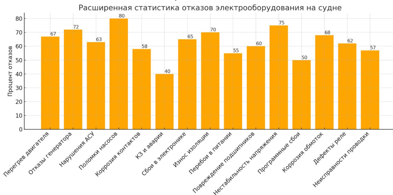
Рис. 2. Расширенная статистика отказов электрооборудования на судне
