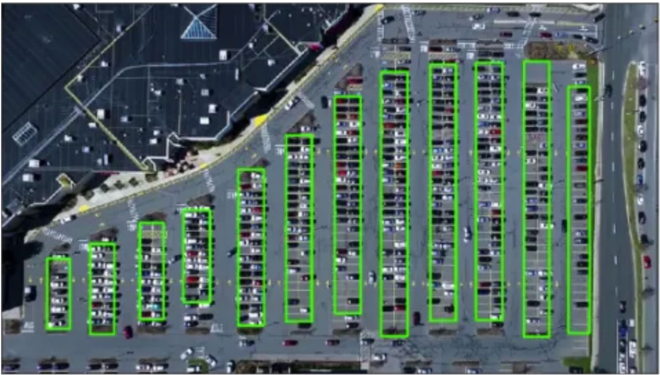
Рис. 3. Определение линий с помощью HoughLines
