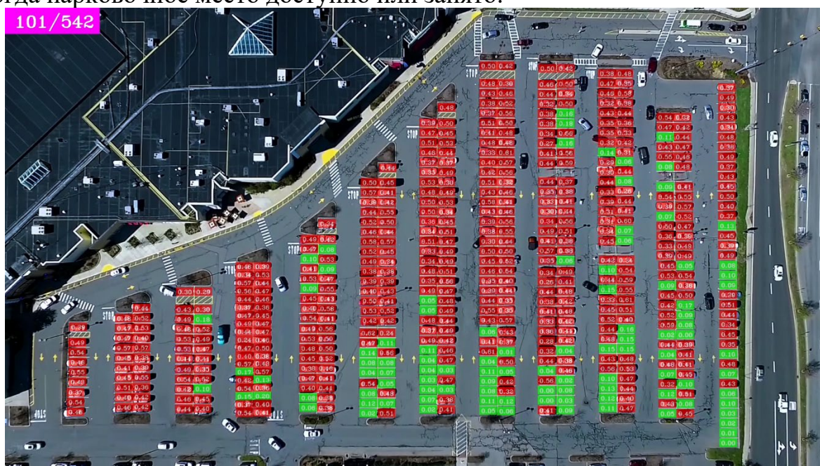
Рис. 1. Определение места парковки в режиме реального времени
