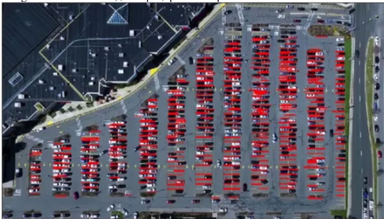
Рис. 2. Определение границ с помощью Canny Edge Detection
