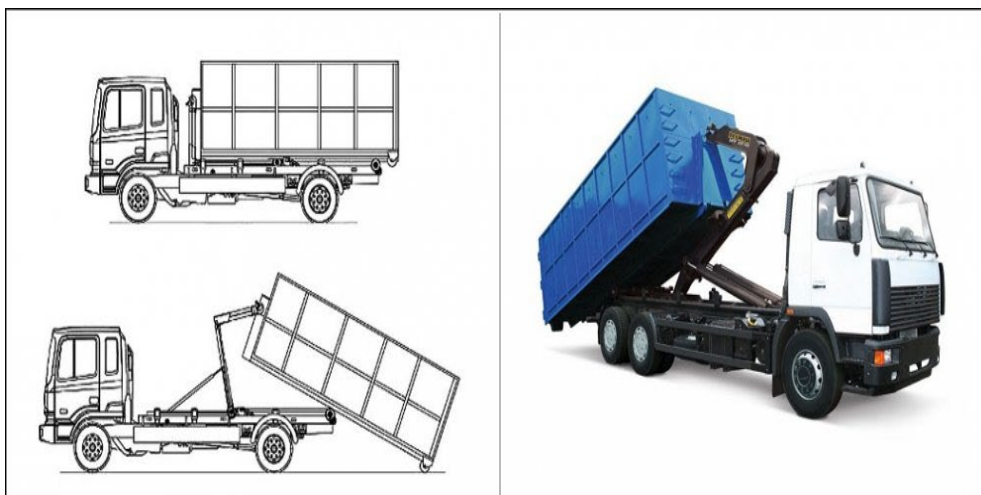
Рис. 1. Принцип работы системы мультилифт на автомобиле
