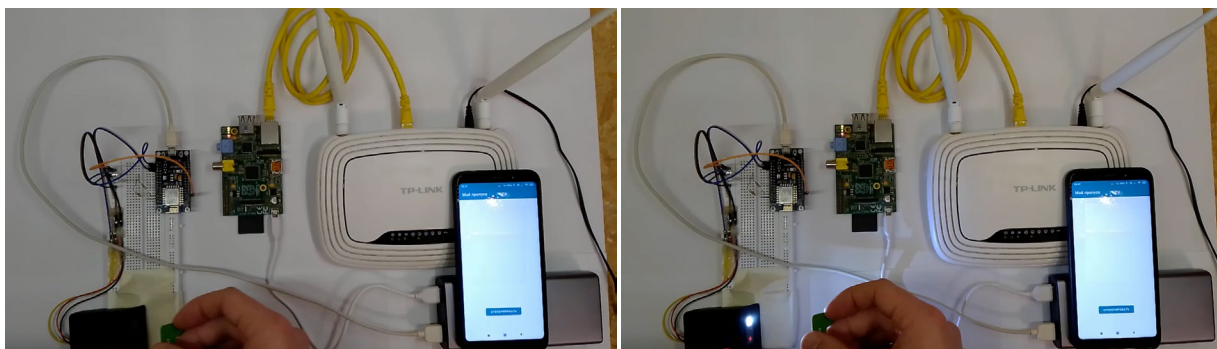
Рис. 4. Считывание штрих-кода или QR-кода, которого нет в списке допустимых
