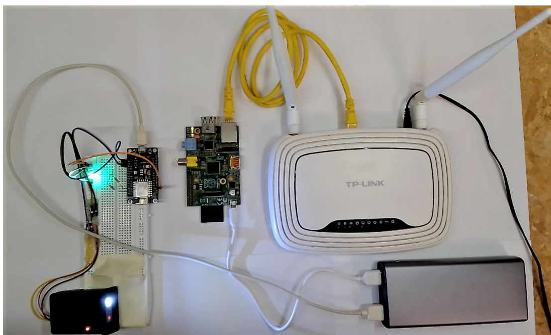
Рис. 3. Прототип «Системы контроля и управления доступом (СКУД)»
