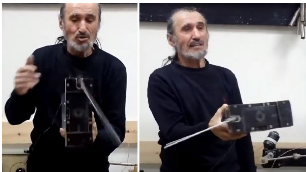
Рис. 2. Горизонтально ориентированный маятник Капицы
