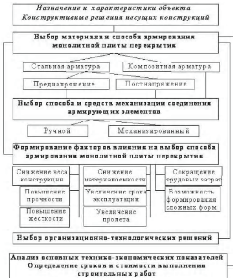
Рис. 1. Блок-схема повышения эффективности возведения монолитной плиты перекрытия
