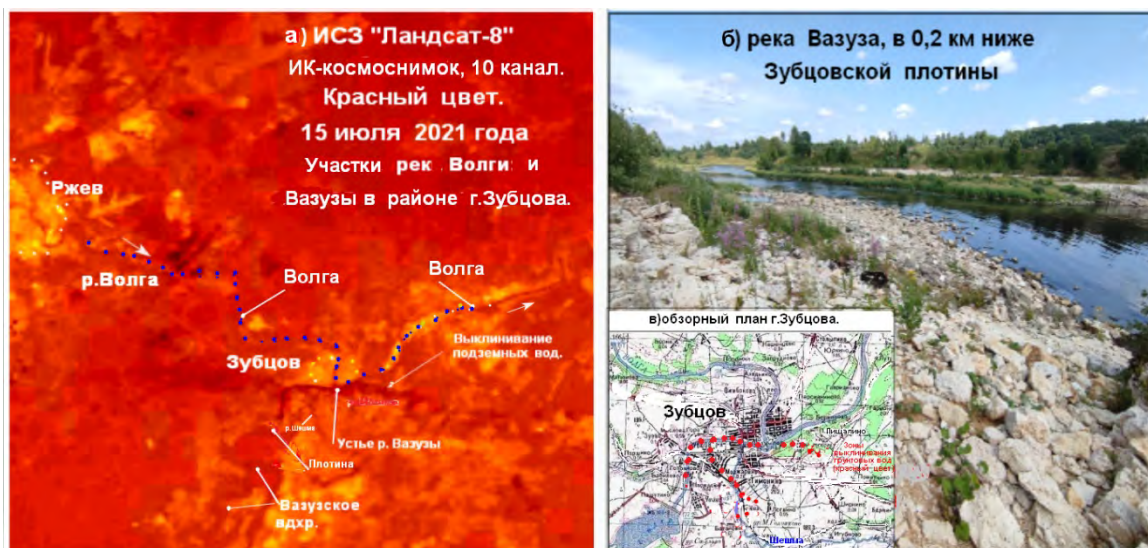
Рис. 15. Выклинивание грунтовых вод ниже плотины Зубцовского гидроузла.
