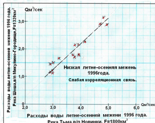
Рис. 16. График связи минимальных суточных летне-осенних расходов воды по двум водотокам: река Тьма- в/п Новинки, F=1800км 2 , и река Шоша - в/п Микулино-Городище, F=1320км 2 . Период наблюдений: низкая летне-осенняя межень 1996 года
