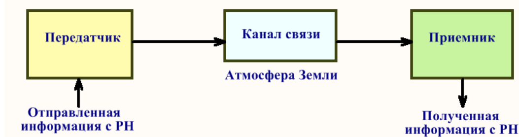
Рис. 1. Схема радиосвязи РН
