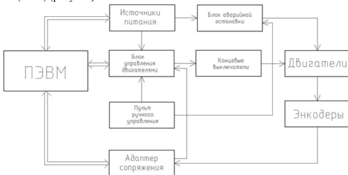
Рис. Структурная схема управляющего комплекса координатно-поворотным устройством
