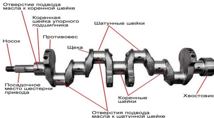
Рис. Конструкция коленчатого вала
