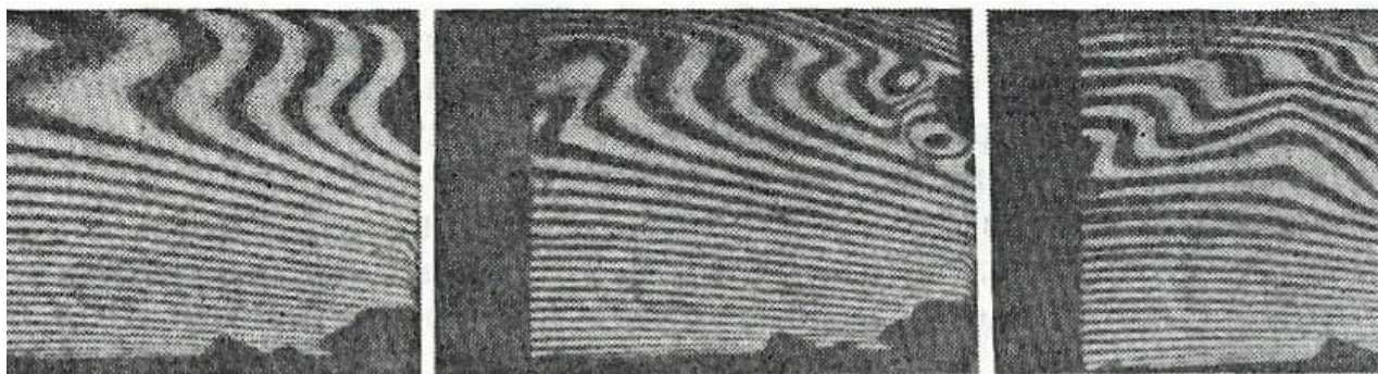
Рис. 4. Интерферограмма развития межфазной турбулентности и деформации пограничного слоя при абсорбции O_2 в водной среде с добавлением ПАВ №3 (фиксация изменения полос на фотографиях с дискретностью 5 сек.)
