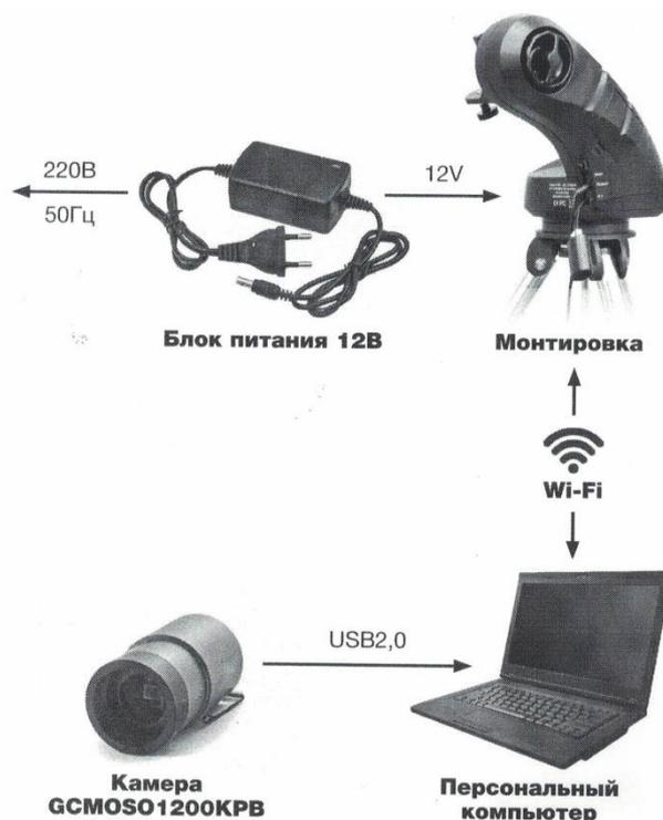
Рис. 6. Схема соединения составных частей телескопа
