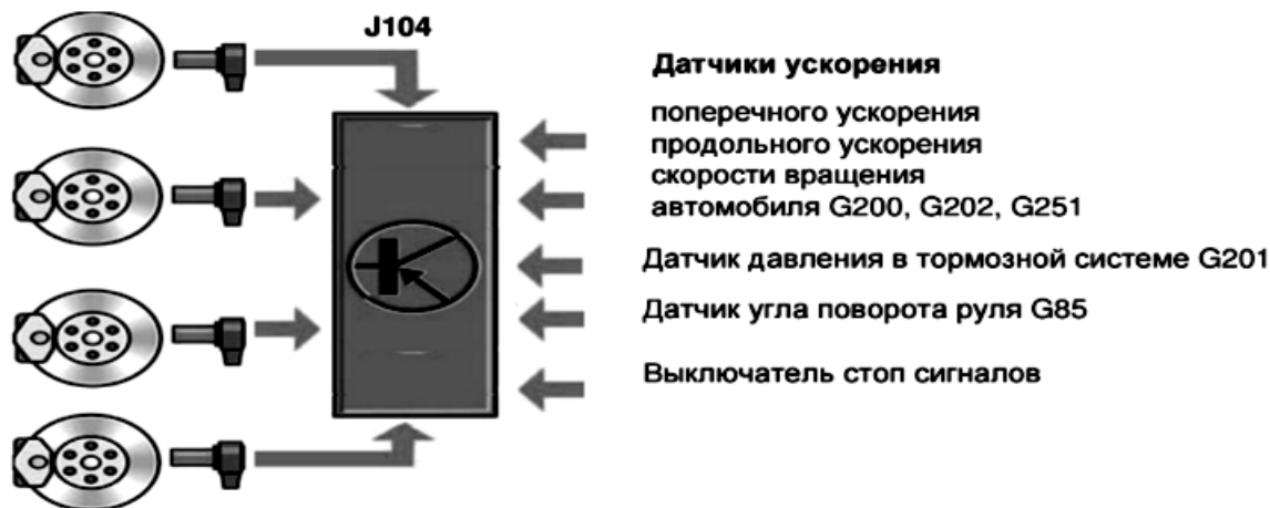
Рис. 2. Принцип работы датчиков ускорения
