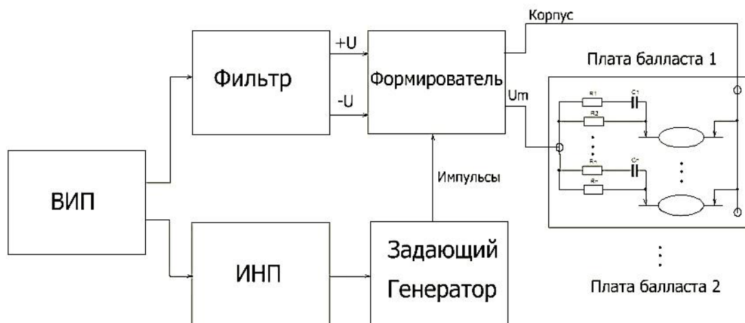
Рис. 3. Функциональная схема импульсного генератора: ВИП – высоковольтный источник питания; ИНП – низковольтный источник питания
