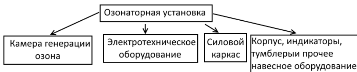
Рис. Принципиальная схема модулей озонаторной установки
