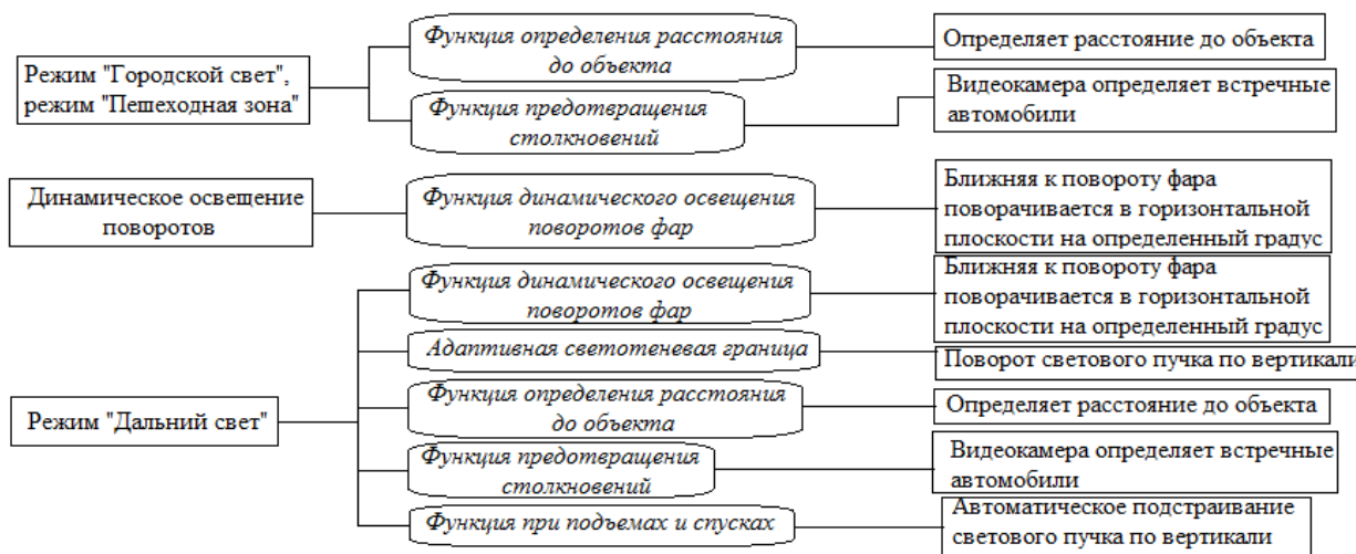
Рис. 1. Функциональная схема САГО
