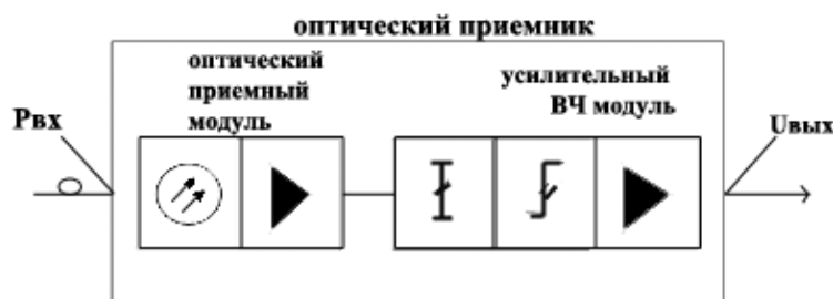
Рис. 1. Структурная схема оптического приемника
