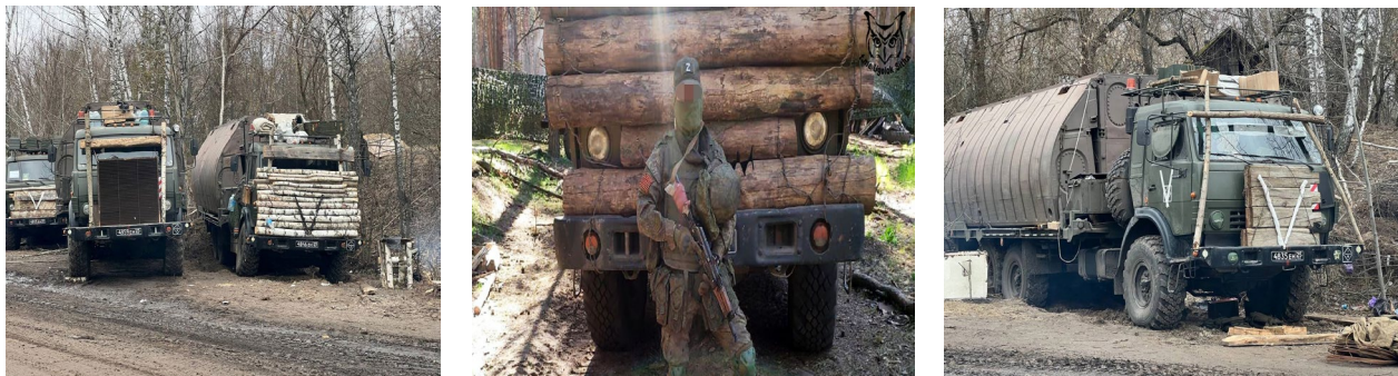
Рис. 2. Автомобили с самодельной защитой
